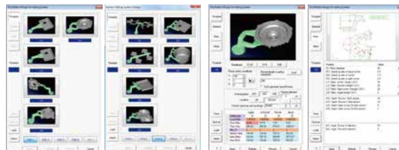
定義済ゲート・システムのテンプレート 設計ページとパラメタ・テーブル
